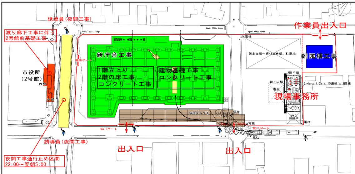
◎新庁舎工事（緑）：建物基礎工事、コンクリート工事、1階の柱・梁工事、2階床工事
