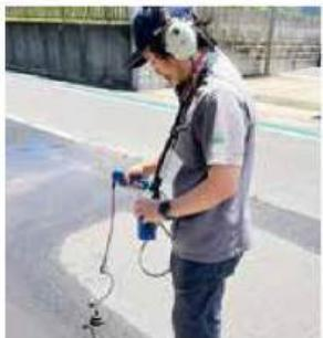
専用の機材を使って道路上で音を聞いて漏水箇所を確認。
