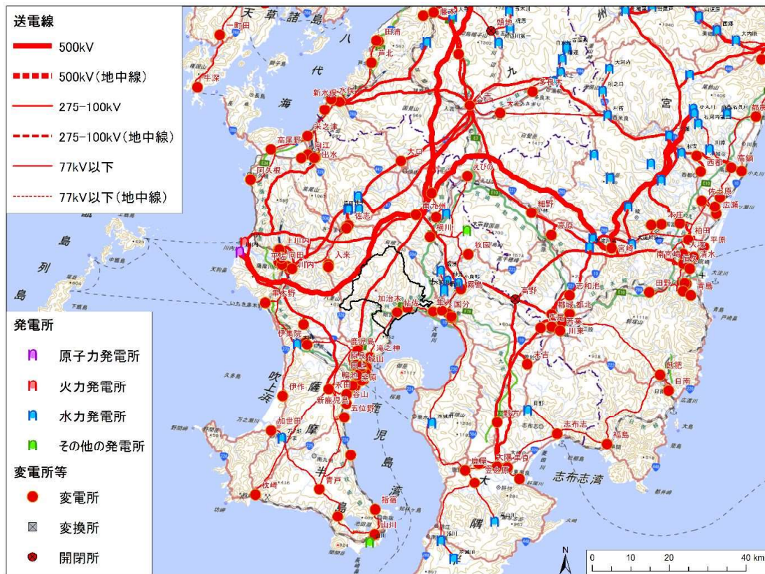
図 19 始良市内送変電設備の状況
