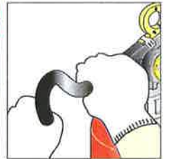
ホースの点検方法 たわませてホースの状態をチェック
