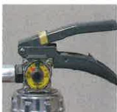
× 安全栓の脱落
