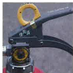
× 表示装置の脱落
