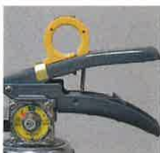
× レバー支えの脱落
