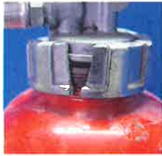
× キャップの破損
