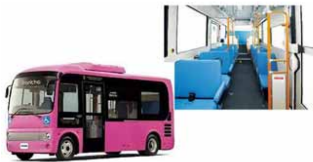
図 V-23 ふるさとバス蒲生・春花線に導入した低床バス ・対象車両の種別：ノンステップ型・スロープ付き ・乗車定員：20名
