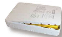
膨張したモバイルバッテリー
